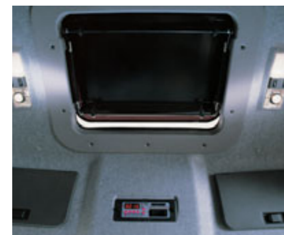
Стальной люк в крыше
