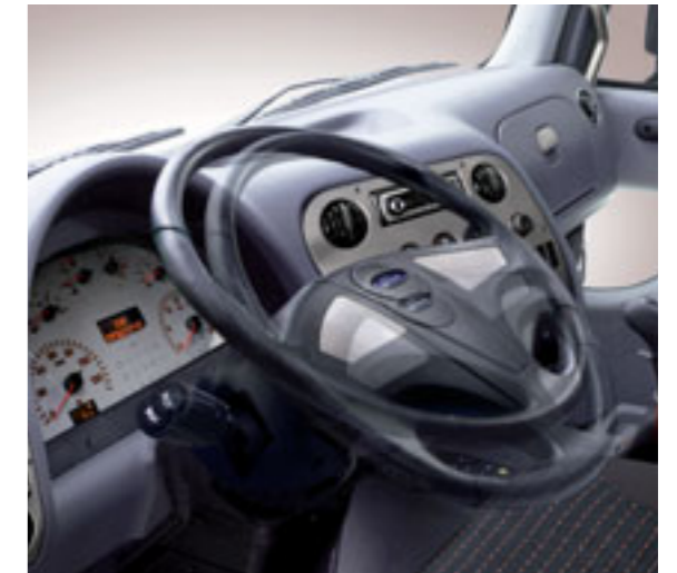
Регулируемая по вылету и углу наклона рулевая колонка
