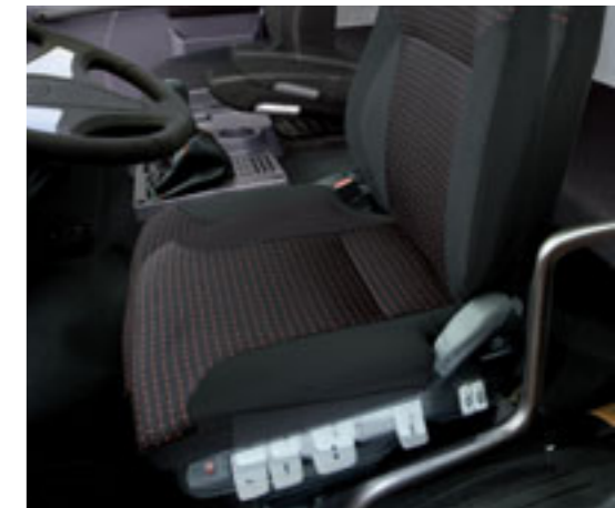
Пневматически регулируемое сиденье водителя
